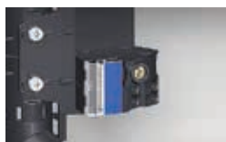
Listwa zaciskowa do przewodów neutralnych łatwo rozdzielana dla przystosowania do zabezpieczeń różnicowoprądowych.
