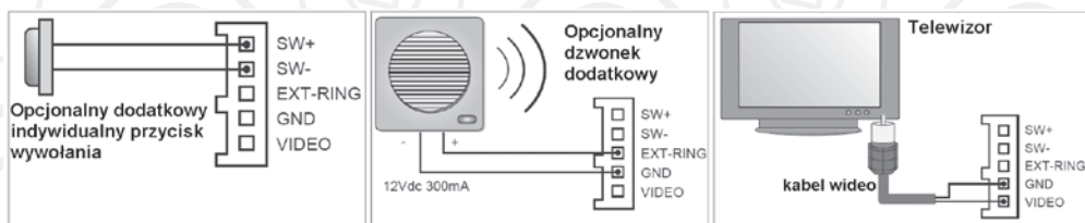
Rys.18. Opcjonalne podłączenie dodatkowych urządzeń do monitora zestawu
