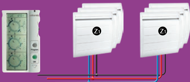
Schemat sieci grzewczej (1 strefy) sterowanej przez programator CHRONOPASS. CHRONOPASS może sterować pracą maksymalnie 15 urządzeń połączonych w sieć.
