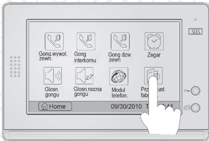
Rys.19. Przywracanie ustawień fabrycznych.
