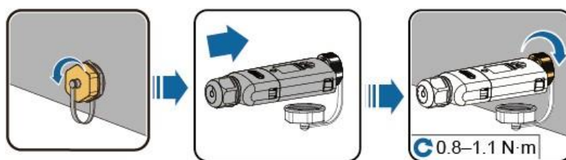
Rysunek 5-10 Montaż WLAN-FE Smart Dongle (komunikacja WLAN)
