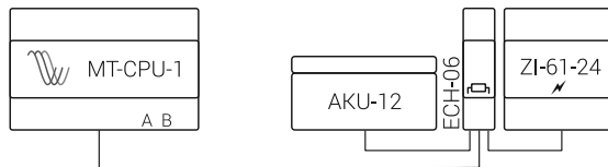
Przykład układu zasilania odbiornika 9÷30 V DC
