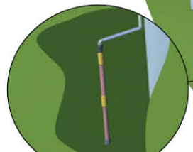
TAŚMA DO IZOLOWANIA PODZIEMNYCH POŁĄCZEŃ INSTALACJI UZIEMIĄCEJ ANTICOR Plast
