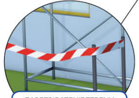
ZABEZPIECZENIE TERENU Taśma ostrzegawcza biało-czerwona 255
