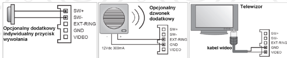
Rys.36. Opcjonalne podłączenie dodatkowych urządzeń do monitora zestawu
